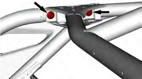
后部侧面紧固件 - 典型示例
