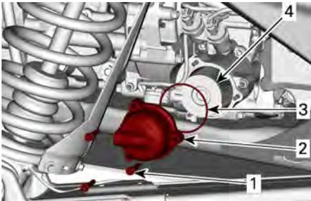
1. Schrauben der Ölfilterabdeckung
