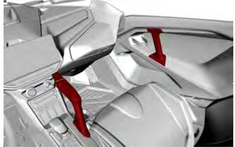
Die Haltegriffe dienen dazu, dass sich der Beifahrer bei starken Fahrzeugbewegungen an ihnen festhält und bei einem Überschlag seine Hände sowie sein gesamter Körper im Cockpit bleiben.
