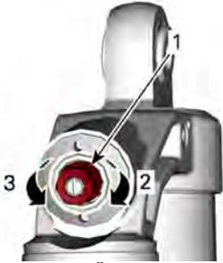
**EINFEDERUNGSDÄMPFUNG BEI HOHER GESCHWINDIGKEIT (EINEN 17-MM SCHRAUBENSCHLÜSSEL VERWENDEN)**
