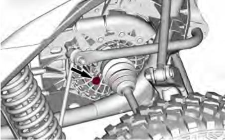
4. Entfernen Sie die Ölfüllstandschraube des Hinterachsgetriebes und den O-Ring.
