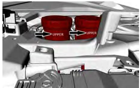
**BREMSEFLÜSSIGKEITSBEHÄLTER – VON DER BEIFAHRESEITE**
