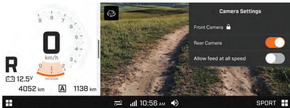
Auf die Kamera kann außerdem über den Touchscreen zugegriffen werden, wenn sich das Fahrzeug nicht im Rückwärtsgang befindet oder der Motor nicht läuft. Anleitungen zum Zugriff finden Sie unter **10,25-ZOLL FARB-TOUCHSCREEN**.
