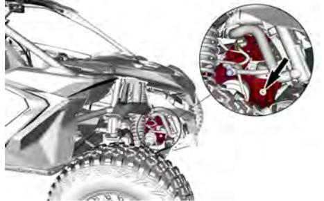
4. Entfernen Sie die Ölfüllstandschraube und den O-Ring.
