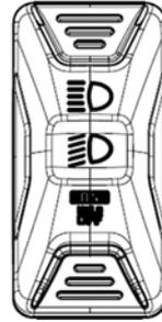
Dieser Schalter wird zum Wechseln zwischen Fern- und Abblendlicht verwendet.
