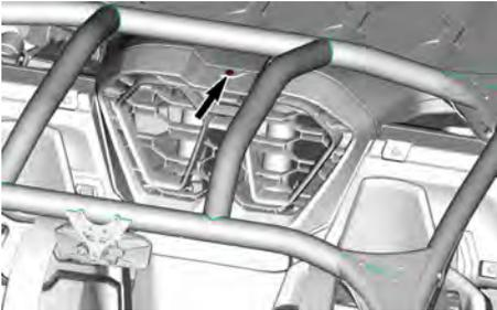
6. Ziehen Sie nach vorne, um das Luftansauggitter zu entfernen.
