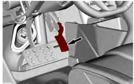
Mit dem Gaspedal wird die Fahrzeuggeschwindigkeit und die Beschleunigung gesteuert.
