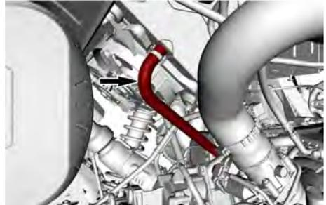
OBERER KÜHLERSCHLAUCH – RADKASTEN DES RECHTEN HINTERRADS
