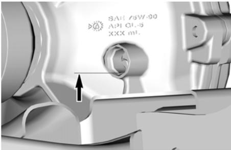
6. Um den Ölstand zu korrigieren, füllen eine Spritze mit dem empfohlenen Vorderachsdifferential-Öl. Siehe *Empfohlenes Vorderachsdifferentialöl*.
