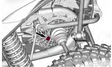
4. Reinigen Sie den Bereich um die Ablassschraube an der Unterseite des Fahrzeugs über das Loch in der Unterbodenschutzplatte des Fahrzeugs aus.
