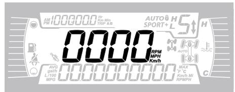
Anzeige der Fahrzeuggeschwindigkeit in km/h oder MPH oder Drehzahl in U/min.
