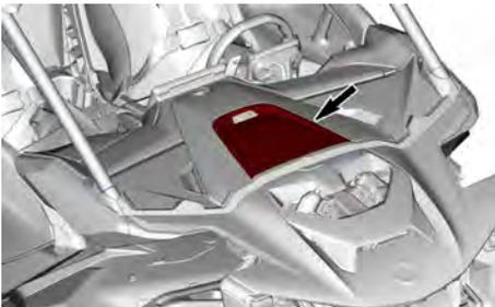
ABDECKUNG DES VORDEREN SICHERUNGSKASTENS
