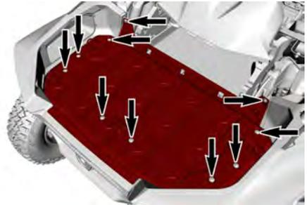
9. Entfernen Sie die Schrauben, mit denen die akustischen Abschirmungen an der Zwischenkühlerhalterung und dem Fahrwerk befestigt sind. Entfernen Sie anschließend die Abschirmungen von jeder Seite des Zwischenkühlers.
