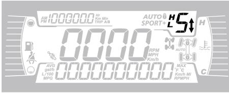
Diese Anzeige zeigt die Getriebestellung an:
