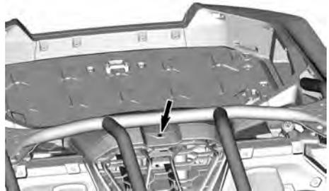
3. Lösen und entfernen Sie anschließend das Luftansauggitter.
