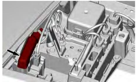
4. Schließen Sie zunächst ein Ende des ROTEN Überbrückungskabels an den Pluspol (+) der entladenen Batterie an.
