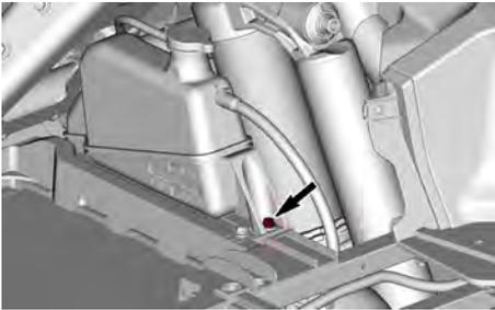
11. Trennen Sie auf der linken Seite den Luftfilteransaugschlauch von der seitlichen Abschirmung.
