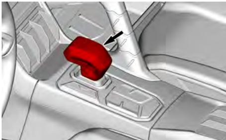
Der Schalthebel wird genutzt, um das Getriebe in die REVERSE-Stellung (Rückwärts fahren) oder DRIVE-Stellung (Vorwärts fahren) zu schalten.
