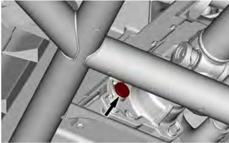
9. Füllen eine Spritze mit dem empfohlenen Öl. Siehe *Empfohlenes Trenneinheitöl*.
