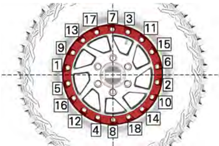
TYYPILLINEN KIRISTYSJÄRJESTYS
