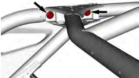
FIXATIONS LATÉRALES ARRIÈRE – TYPIQUE
