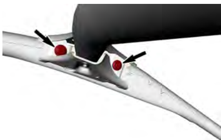
FIXATIONS LATÉRALES AVANT — TYPIQUE
