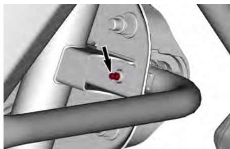
BARRE STABILISATRICE ARRIÈRE - CÔTÉ GAUCHE - TYPIQUE
