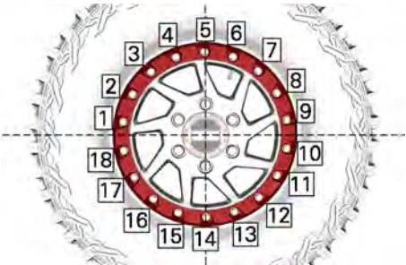
TYPIQUE - SÉQUENCE DE SERRAGE FINAL
