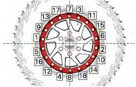
SITUAZIONE TIPICA - SEQUENZA DI SERRAGGIO
