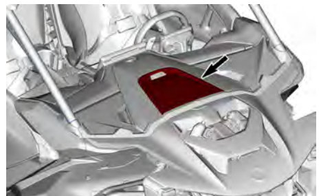
DEKSEL PÅ SIKRINGSBOKS FORAN
