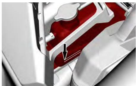
4. Fyll på kjølevæske i beholderen hvis det er nødvendig. Se *Påfylling og lufting av kjølesystemet*
