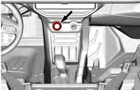
Når D. E. S. S.-nøkkelen er satt inn, trykkes og holdes MOTORENS START/STOPP-knapp for å starte motoren.
