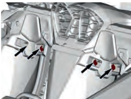
4. Fjern de fire skruene, to bak hvert sete, som holder ladeluftkjølerstøtten på den bakre sentrale delen.
