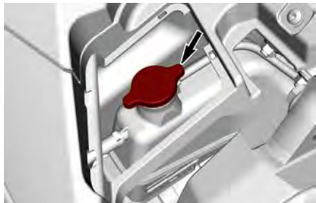
2. Fyll kjølevæske til nivået når MAX-linjen på kjølevæskebeholderen. Se *Anbefalt motorkjølevæske*. Bruk en oljetrakt for å unngå søl. **Ikke fyll for mye.**
