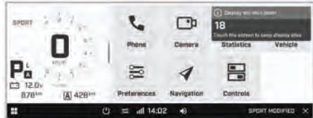
Berøringsskjermen vil deretter være PÅ i en time etter den siste handlingen på berøringsskjermen eller til batterinivået faller til 11,8 V.
