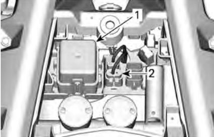
1. Vorderer Sicherungskasten
