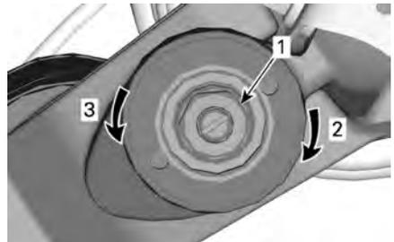
**EINFEDERUNGSDÄMPFUNG (HOHE GESCHWINDIGKEIT), (EINEN 17-MM-SCHRAUBENSCHLÜSSEL VERWENDEN)**
