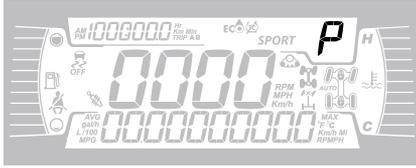
Diese Anzeige zeigt die Getriebestellung an:
