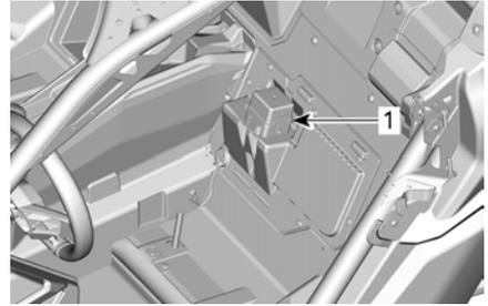
1. Hinterer Sicherungskasten
