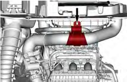
Heben Sie die Zwischenkühlerbau-
