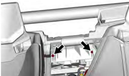
Entfernen Sie die Schutzplatte.
