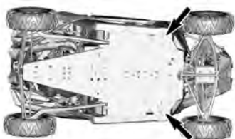
POSITIONS DES CHANDELLES - AVANT DU VÉHICULE
