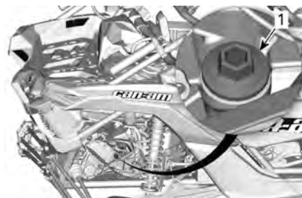
1. Bouchon du niveau d'huile de boîte de vitesses
