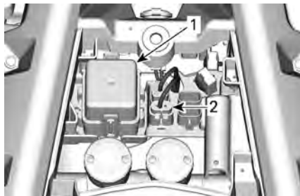
1. Scatola fusibili anteriore
