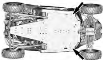
POSIZIONI DEL MARTINETTO - LATO ANTERIORE DEL VEICOLO
