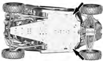
KRIKPOSITIES - VOORKANT VAN HET VOERTUIG
