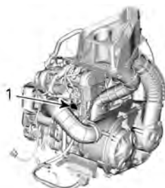
TYPISK — DEKAL MED MOTORENS SERIENUMMER
