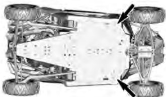
POSISJONER FOR JEKK – FREMSIDEN AV KJØRETØYET
