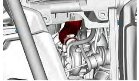
Abra el intercooler y el soporte del tubo del cárter del cigüeñal desmontando el tornillo.
