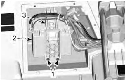
1. Tornillos de sujeción del portabaterías
