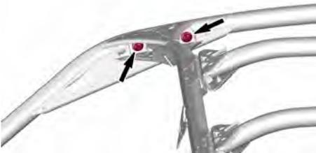
**SUJECIONES DELANTERAS SUPERIORES**
