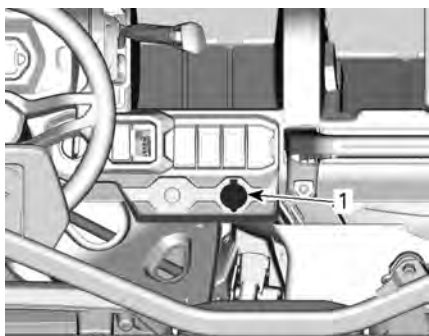
1. Tomas de corriente de 12 voltios
