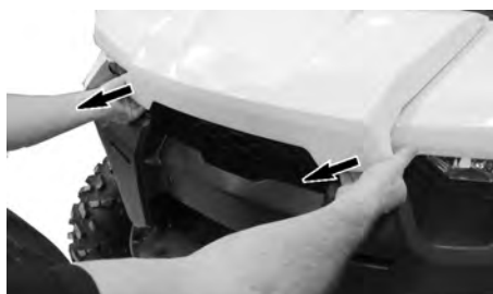
TIREZ SUR LE BORD AVANT DU COUVERCLE D'ENTRETIEN.
