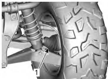
1. Fuelles exteriores del eje motriz
