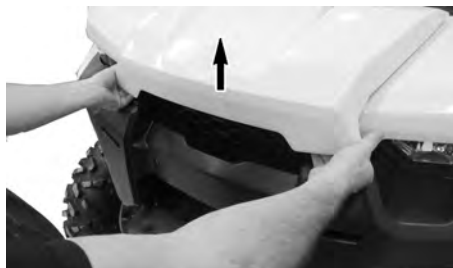
DE RAND VAN HET VOORSTE ONDERHOUDSDEKSEL OPTILLEN.
