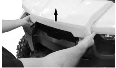
LEVANTANDO A BORDA DA TAMPA DE MANUTENÇÃO FRONTAL.
