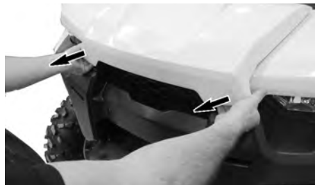
TIRARE DAL BORDO COPERCHIO DI MANUTENZIONE ANTERIORE.
