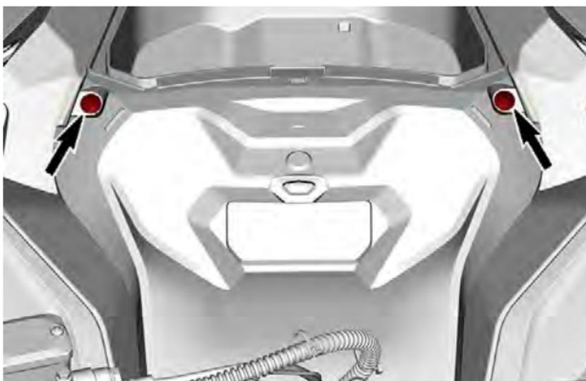
2. Sollevare la parte anteriore del supporto dell'indicatore, quindi farlo scivolare in avanti per rimuoverlo.
