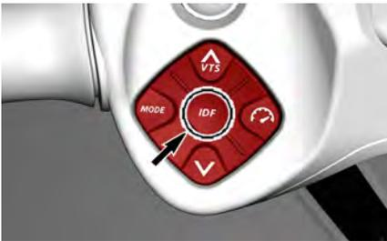
Ermöglicht die Betätigung des iDF--Systems. Siehe *Aktivieren des intelligenten verschmutzungsfreien Pumpsystems* im Abschnitt *Betriebsanleitungen*.
