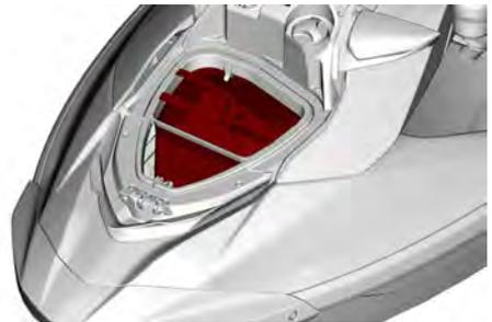
Ziehen Sie an der Lasche zum Entriegeln, und ziehen Sie den Beutel nach oben, um ihn vom Wasserfahrzeug zu entfernen.
