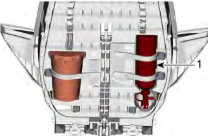
1. Extintor de incêndio
