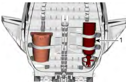
1. Extintor de incendios
