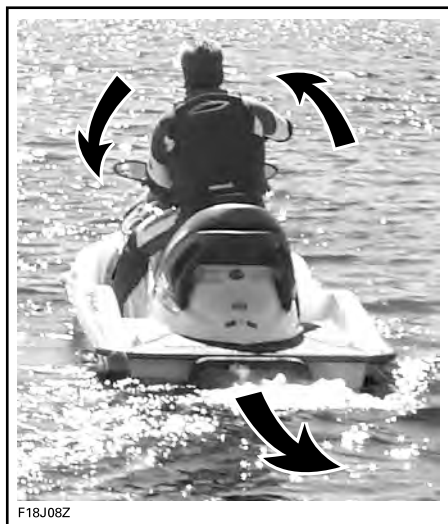
TYPBILD - STYRRIKTNINGEN OMKASTAD VID BACKNING
