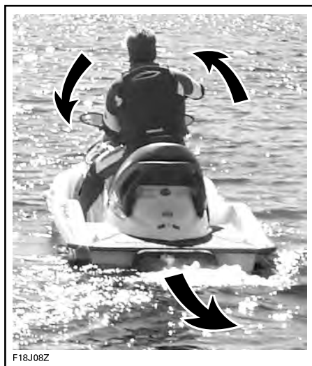
TYPIQUE - INVERSION DE LA DIRECTION EN MARCHÉ ARRIÈRE
