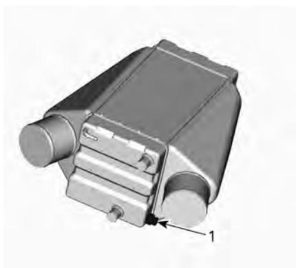
Controllare gli anodi sacrificali per verificare che non siano usurati. Se più della metà è usurata, sostituirli.
