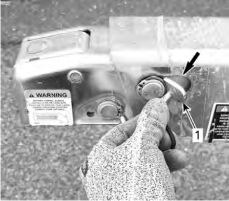
1. Goupille de blocage de marche arrière
