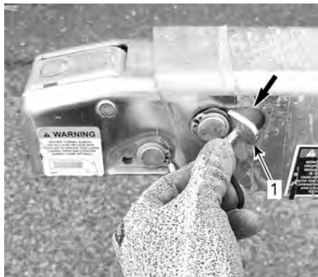
1. Goupille de blocage de marche arrière
