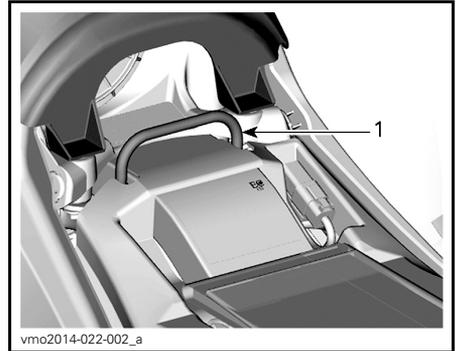
1. Mécanisme de retenue avant
