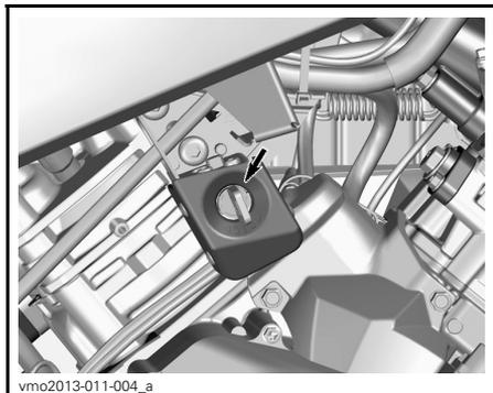
**REMARQUE:** Le dispositif antivol du véhicule n'agit pas si le levier sélecteur n'est pas à la position de stationnement lorsque le mécanisme est engagé.
