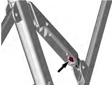
BOULON DE TENSION BIMINI – CÔTÉ GAUCHE
