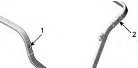
VIS DE LA STRUCTURE DU BIMINI AU MILIEU ET À L'ARRIÈRE - CÔTÉ GAUCHE
