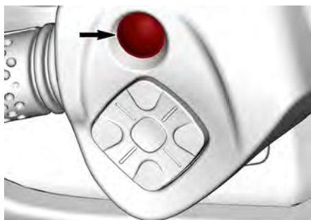
TYPIQUE - BOUTON START/STOP DU MOTEUR
