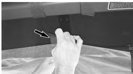
INSTALLEZ LA GRANDE SANGLE PAR DESSUS LA PETITE SANGLE.
