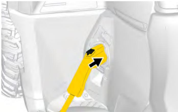
9. Assurez-vous que ce câble de charge est correctement verrouillé dans le port de charge du véhicule :
