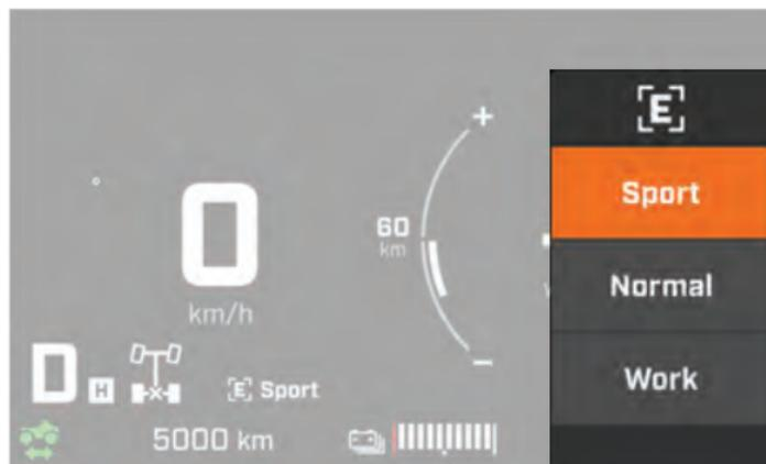
Le mode moteur peut être modifié à l'aide du **sélecteur de mode moteur** situé sur le commutateur multifonction droit. Se reporter à [Fonctionnement du commutateur multifonction droit](#), page 3-24.
