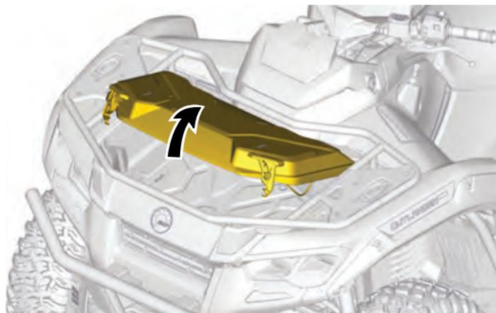
Utilisez le levier situé à l'intérieur du compartiment de rangement pour verrouiller le couvercle en position ouverte.
