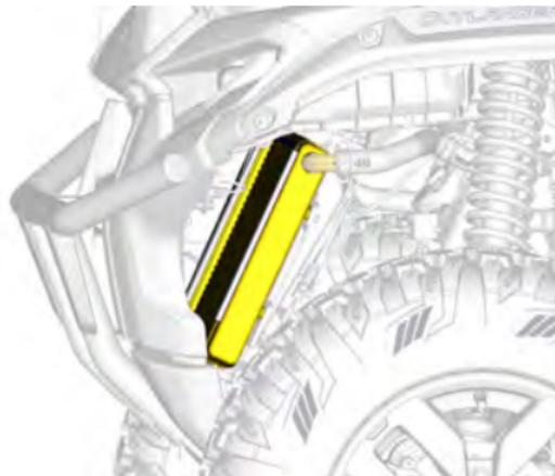
1. Retirez le rivet en plastique des déflecteurs d'air avant situés de chaque côté du radiateur.
