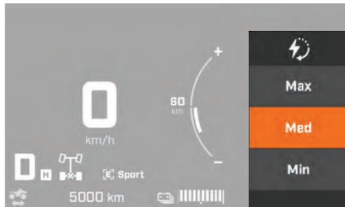
Le freinage à récupération d'énergie est désactivé au-delà de 90 % du niveau de charge et lorsque la température de la batterie est inférieure à 0 ° C (32 ° F). Pour plus d'informations sur la manière de préconditionner la batterie afin d'optimiser ses performances à basse température. Reportez-vous à la section [Préconditionnement du véhicule, page 3-146](#).
