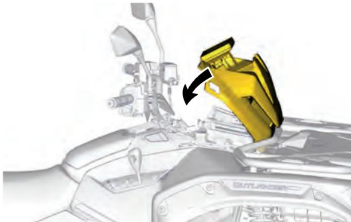
7. Appuyez sur le bord arrière gauche de la console au-dessus de la languette de la boîte
