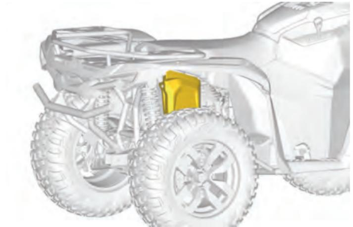
4. Retirez le capuchon de la borne positive de la batterie et nettoyez la corrosion sur la
