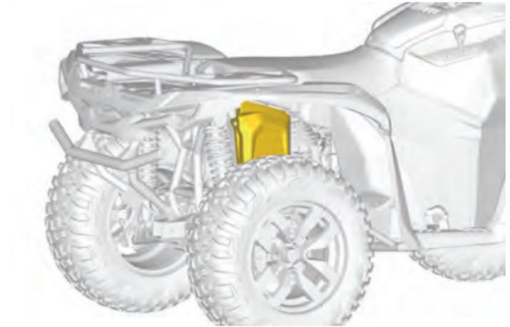
4. Retire la tapa del terminal positivo y limpie la corrosión de los bornes de la batería antes de conectar los cables de puente.
