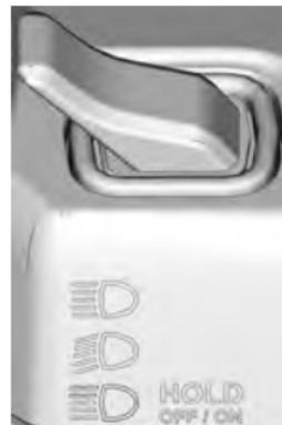
Este interruptor se utiliza para activar o desactivar las luces altas. Al encender el vehículo, las luces bajas se encenderán de forma automática y se apagarán cuando se apague el vehículo.
