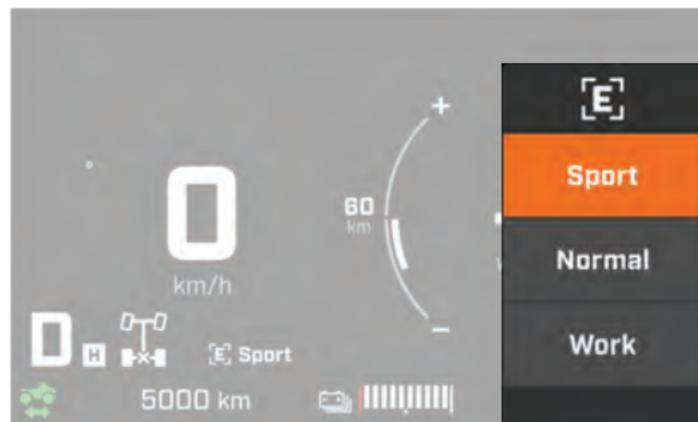
El modo del motor puede modificarse utilizando el **selector de modo de motor** que se ubica en el interruptor multifuncional derecho. Consulte [Funcionamiento del interruptor multifunción derecho](#), página 3-24.
