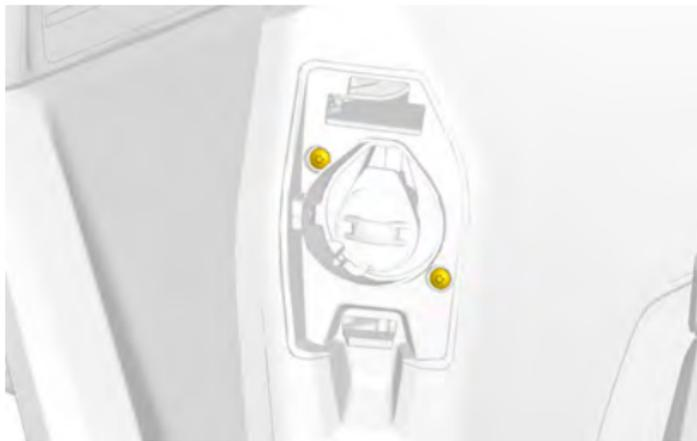
4. Tire del panel hacia afuera del bastidor.
