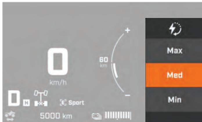
El frenado regenerativo no está disponible cuando el estado de carga (SOC) supera el 90 %, ni cuando la temperatura de la batería está por debajo de 0 °C (32 °F). Para información sobre cómo preacondicionar la batería y optimizar su rendimiento en temperaturas frías, consulte [Preacondicionamiento del vehículo, página 3-146](#).
