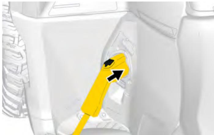
9. Asegúrese de que el cable de carga del EVSE esté acoplado correctamente en el puerto de carga del vehículo.
