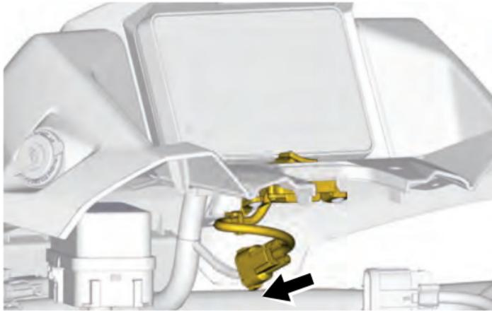
5. Instale los dos conectores de pala en el tomacorriente de 12 V.
