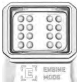
El **selector del modo del motor** se utiliza presionándolo para alternar entre los distintos modos de motor. Consulte el apartado [Modalidades del motor, página 3-157](#) para obtener información adicional.
