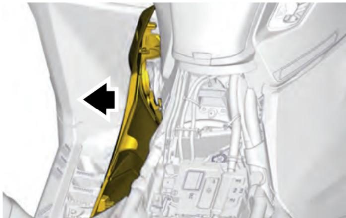
6. Desacople los conectores eléctricos de la luz del puerto de carga de la siguiente manera:
