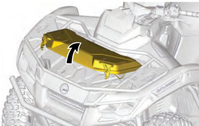
Utilice la palanca ubicada dentro del compartimento para asegurar la tapa en posición abierta.
