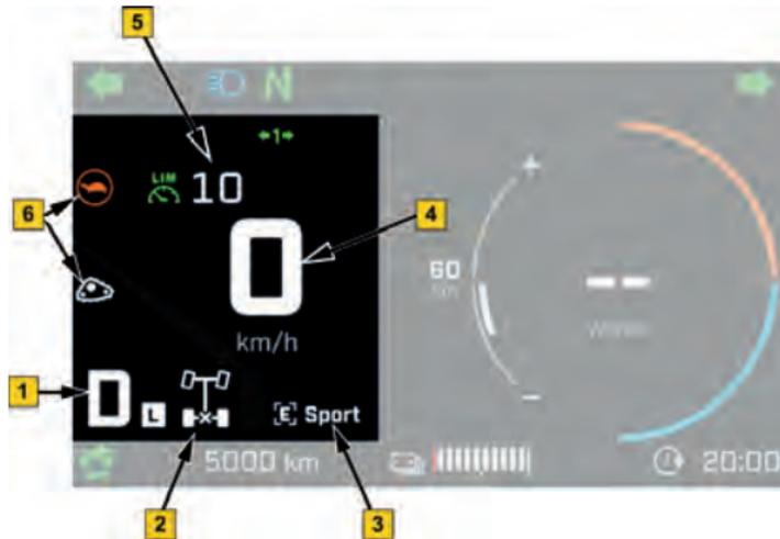
1. Posición seleccionada de la palanca de cambios:
