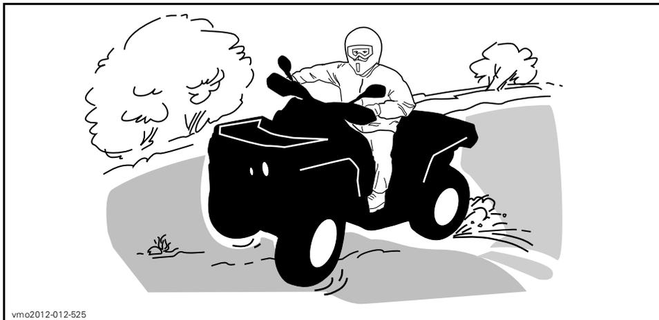
Si le véhicule se met à glisser, tourner le guidon dans le même sens que la direction du glissement jusqu'à ce que vous repreniez contrôle du véhicule. Ne jamais ser-
