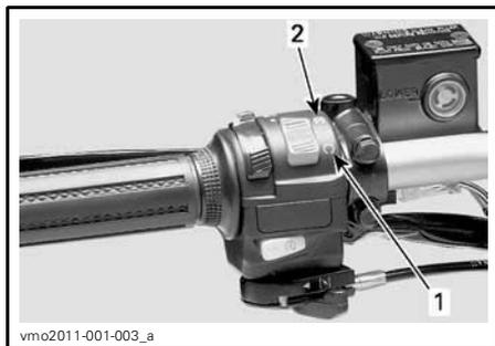
**TYPIQUE — INTERRUPTEUR D'ARRÊT D'URGENCE DU MOTEUR**
