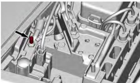
5. Schließen Sie dann das andere Ende des ROTEN (+) Überbrückungskabels an den Pluspol (+) der Fremdstartbatterie an.
