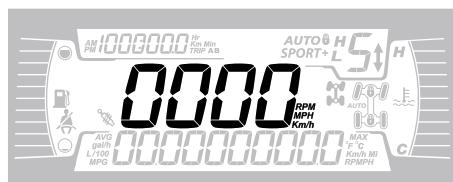
Anzeige der Fahrzeuggeschwindigkeit in km/h oder MPH oder Drehzahl in U/min.
