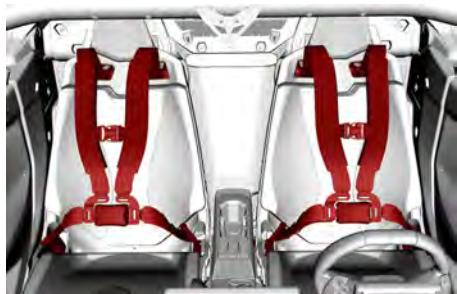
1. Um den Gurt anzuschnallen, führen Sie die Druckstiftplatte in das Gurtschloss, ziehen dann am Gurt und vergewissern sich, dass er ordnungsgemäß eingerastet ist.
