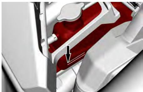
4. Geben Sie nach Bedarf Kühlmittel in den Behälter. Siehe *Kühlsystem befüllen und entlüften*
