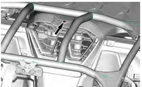
6. Ziehen Sie nach vorne, um das Luftansauggitter zu entfernen.
