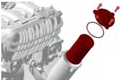
2. Entfernen Sie die Ölfilterabdeckung. Werfen Sie den O-Ring weg.
