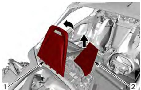
1. Abdeckung des Sicherungskastens
