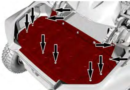
9. Entfernen Sie die Schrauben, mit denen die akustischen Abschirmungen an der Zwischenkühlerhalterung und dem Fahrwerk befestigt sind. Entfernen Sie anschließend die Abschirmungen von jeder Seite des Zwischenkühlers.
