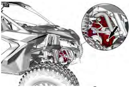
4. Entfernen Sie die Ölfüllstands schraube und den O-Ring.
