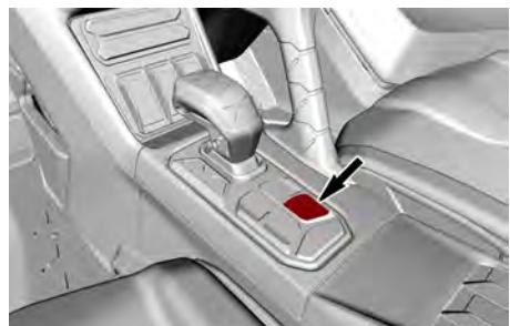
Diese Taste dient zum Aktivieren oder Deaktivieren des manuellen Schaltmodus.
