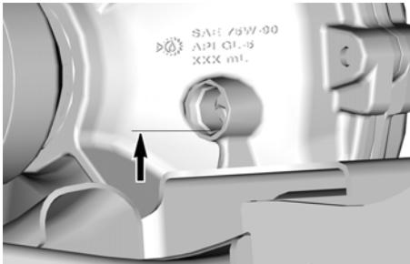
6. Um den Ölstand zu korrigieren, füllen eine Spritze mit dem empfohlenen Vorderachsendifferential-Öl. Siehe *Empfohlenes Vorderachsendifferentialöl*.
