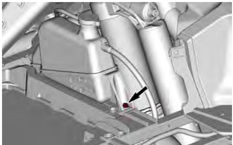
11. Trennen Sie auf der linken Seite den Luftfilteransaugschlauch von der seitlichen Abschirmung.
