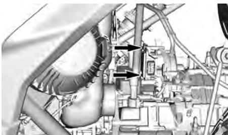
5. Entfernen Sie den Getriebeaktor.
