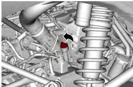
6. Führen Sie den Ölmessstab wieder ein und schrauben Sie ihn vollständig fest.
