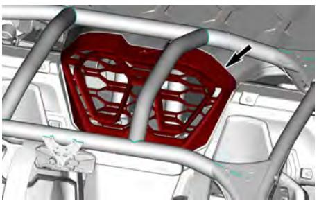
7. Bauen Sie die Kunststoffnieten und Schrauben aus, mit denen die Luftansaugbaugruppe am Gepäckträger befestigt ist. Bauen Sie anschließend die Luftansaugbaugruppe aus.
