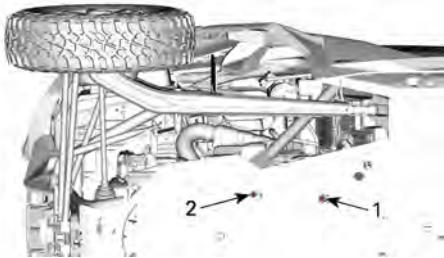
1. Magnetische Ablassschraube der Magnetzunderabdeckung
