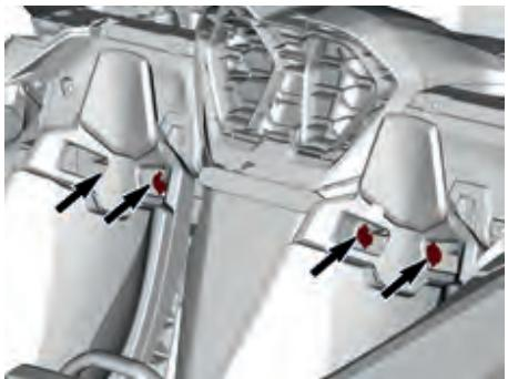
4. Entfernen Sie die vier Schrauben, zwei hinter jedem Sitz, mit denen die Ladeluftkühlerhalterung an der hinteren Mitteltrennwand befestigt ist.
