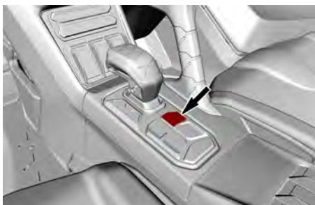
Diese Taste ermöglicht die Auswahl des niedrigen Geschwindigkeitsbereichs für das Getriebe.
