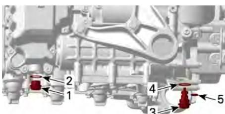
1. Magnetische Ablassschraube für Öltankdeckel
