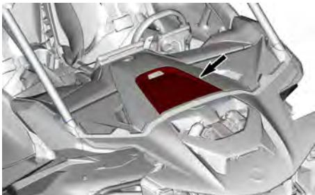
**ABDECKUNG DES VORDEREN SICHERUNGSKASTENS**
