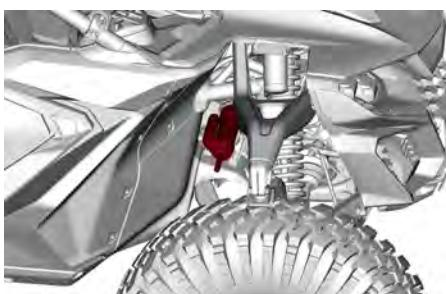
Dieser Dämpfer verfügt über ein vom Benutzer anpassbares Einstellrad mit einer Skala von 1 (leichte Dämpfung) bis 3 (maximale Dämpfung). Eine niedrigere Einstellung ermöglicht einen geringeren Lenkaufwand und eignet sich für den gelegentlichen Einsatz im Gelände. Eine höhere Einstellung erhöht den Dämpfungswiderstand und ist ideal für Bedingungen wie beim Rock-Crawling.
