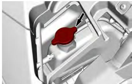
2. Geben Sie Kühlmittel hinzu, bis der Stand die Linie MAX am Kühlmittelbehälter erreicht. Siehe *Empfohlenes Motorkühlmittel*. Mit einem Trichter vermeiden Sie das Verschütten von Flüssigkeit. **Nicht überfüllen**.
