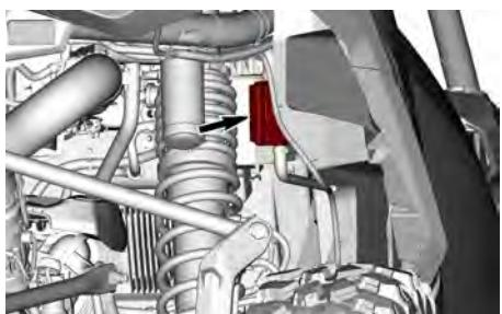
1. Entfernen Sie die Oetiker-Schellen, mit denen die Ein- und Auslassschläuche am Vorfilter befestigt sind.
