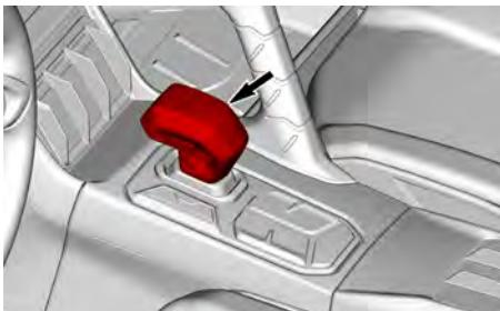
Der Schalthebel wird genutzt, um das Getriebe in die REVERSE-Stellung (Rückwärts fahren) oder DRIVE-Stellung (Vorwärts fahren) zu schalten.
