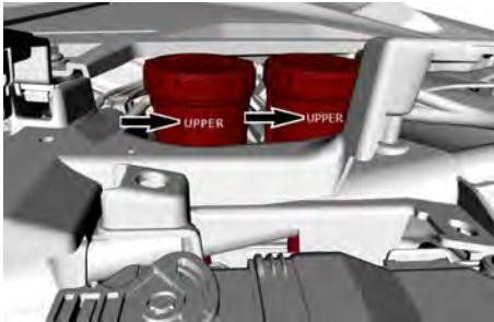
**BREMSFLÜSSIGKEITSBEHÄLTER – VON DER BEIFAHRERSEITE**
