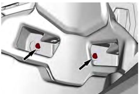
5. Entfernen Sie die Kunststoffniete von der Oberseite des Luftansauggitters.
