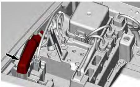
4. Schließen Sie zunächst ein Ende des ROTEN Überbrückungskabels an den Pluspol (+) der entladenen Batterie an.
