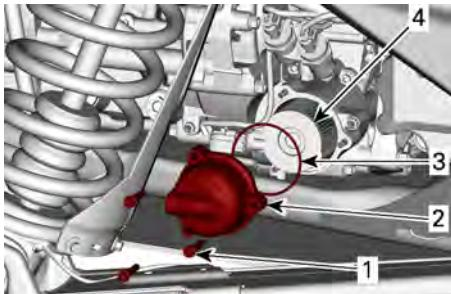
1. Schrauben der Ölfilterabdeckung
