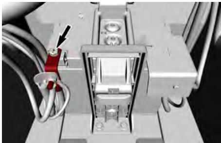
2. Entfernen Sie die zwei Sechskantschrauben und die Unterlegscheiben aus, mit denen die Batteriehalterung an der Unterseite des Batteriefachs befestigt ist.
