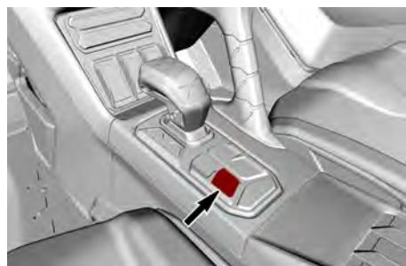
Mit dieser Taste wird das Getriebe in die Neutralstellung gebracht.
