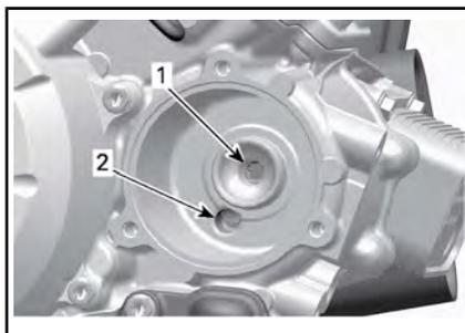
1. Auslass-Bohrung zur Ölspeisung des Motors
