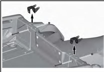
6. Entfernen Sie die Seitenhalterungen von den Seitenwänden.
