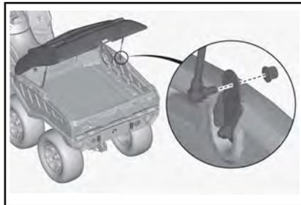
3. Entfernen Sie die Stifte aus den Scharnieren an beiden Seiten.
