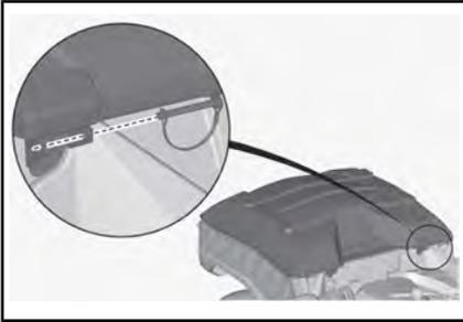
7. Installieren Sie das untere Ende des Dämpfers.
