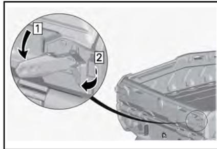
2. Klappen Sie die Heckklappe herunter.
