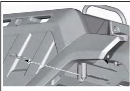
4. Entfernen Sie an beiden Seiten die Verriegelungsgriffe.
