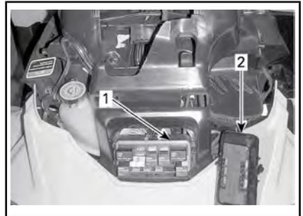
1. Vorderer Sicherungskasten
