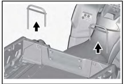
5. Heben Sie die Seitenwand hoch und entfernen Sie sie.
