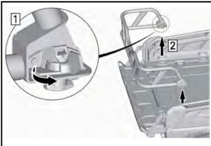
3. Entfernen Sie die Stützhalterungen von der Heckklappe.
