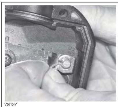
Entfernen Sie die Seitenabdeckung der Drosselklappe.
