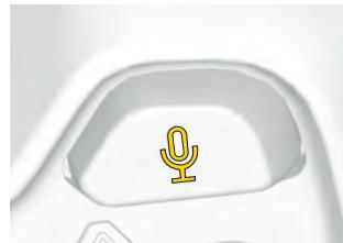
Mit dieser Taste können Sie den Sprachassistenten Ihres Telefons aktivieren. Zur Verwendung dieser Funktion muss der Bediener über ein Telefon und ein Headset verfügen, die über Bluetooth verbunden sind.
