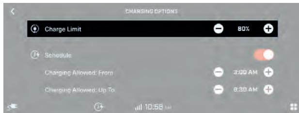
Das Fahrzeugdisplay wechselt zum Ladebildschirm. Der Ladevorgang wird fortgesetzt, bis der Ladezustand der Batterie den ausgewählten Wert erreicht oder der Anschluss zur Ladestation getrennt wird.
