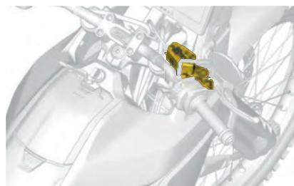
Behälter für Bremsflüssigkeit der vorderen Bremse
