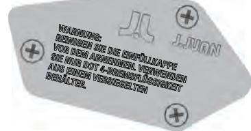
Bremsflüssigkeit für Vorderradbremse
