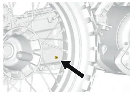
8. Füllen Sie das Kettengehäuse mit **neuem** Öl, bis es aus der Kontrollöffnung tropft.
