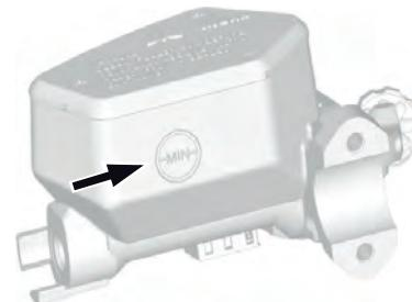
5. Vérifiez le niveau de liquide de frein dans le réservoir arrière. Le niveau de liquide doit se situer entre les repères UPPER et LOWER (Haut et Bas).
