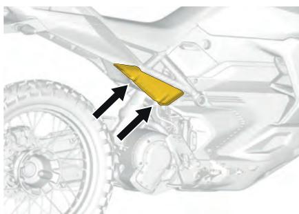
2. Pour le côté gauche : Installez les carénages latéraux inférieurs arrière gauches et les deux vis de fixation des carénages latéraux inférieurs arrière.
