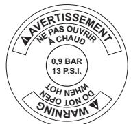
Bouchon du réservoir de liquide de refroidissement
