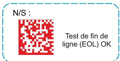
Étiquette Numéro de série Batterie à haute tension
