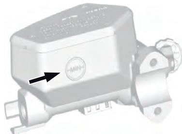
5. Verificare il livello del liquido dei freni nel serbatoio posteriore. Il livello del liquido deve essere compreso tra la tacca SUPERIORE e quella INFERIORE;
