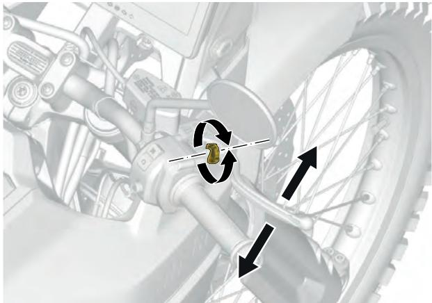
La posizione della leva del freno anteriore può essere regolata ruotando la rotella di regolazione situata all'inizio della leva, tra la leva e la manopola dell'acceleratore. Ruotando la rotella in senso orario o antiorario si regola la distanza tra la leva e la manopola dell'acceleratore.
