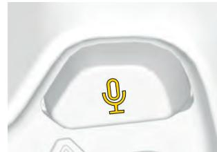
Serve per attivare l'assistente vocale del telefono. Per utilizzare questa funzione, il conducente deve disporre di un telefono e di una cuffia collegati tramite Bluetooth.
