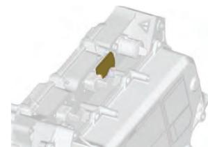
**Batteria ad alta tensione**
