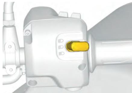
L'interruttore viene utilizzato per attivare e disattivare gli abbaglianti. Gli anabbaglianti si accendono automaticamente quando il veicolo viene attivato e si spengono quando il veicolo viene spento.
