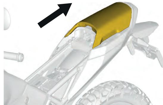
2. Installare il sedile del conducente. Fare riferimento a [Installazione del sedile del conducente, pagina 3-24](#).
