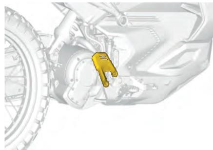
2. Installare le viti di fissaggio del paratalloni. Serrare come da specifiche.
