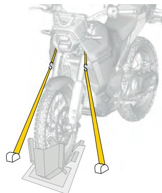
7. Far passare una cinghia di sicurezza all'interno del cerchione di una sola ruota. Non far passare la cinghia di sicurezza al di sopra del braccio oscillante o utilizzare le razze delle ruote per fissare il veicolo.
