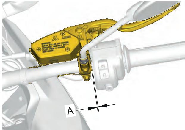
A. Da 0 a 5 mm (da 0 a 0,197 in) tra la punta del manubrio e il lato della leva del freno.
