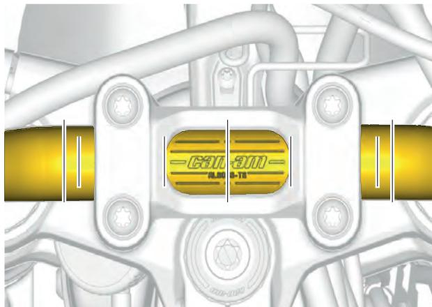
4. Serrare i quattro dispositivi di fissaggio secondo le specifiche.
