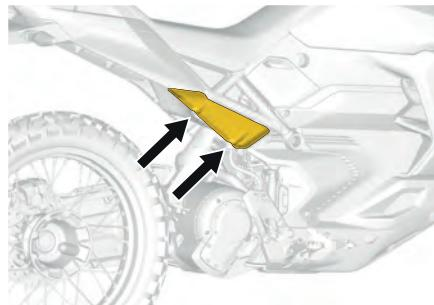
2. Per il lato sinistro: Rimuovere le due viti di fissaggio della carenatura laterale inferiore posteriore e rimuovere la carenatura sinistra dal veicolo.
