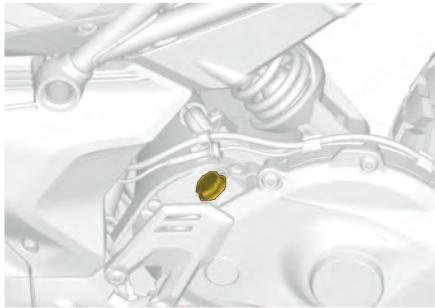
4. Rimuovere i tappi di scarico sul fondo della scatola di trasmissione e rimuovere le particelle metalliche dai tappi di scarico.
