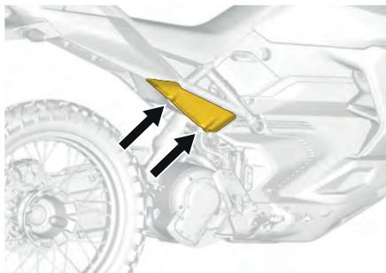
2. Per il lato sinistro: Installare le carenature laterali inferiori posteriori a sinistra e le due viti di fissaggio della carenatura laterale inferiore posteriore.
