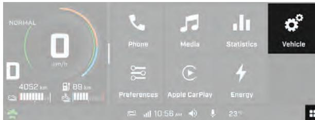
Una volta nelle impostazioni del veicolo, il conducente può selezionare l'icona della marcia e modificare in modo indipendente entrambe le modalità di rigenerazione.
