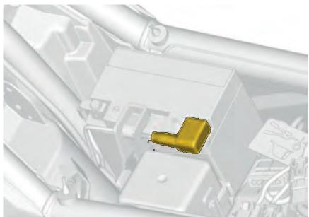
6. Collegare un'estremità del cavo di avviamento ROSSO al polo positivo (+) della batteria scarica.
