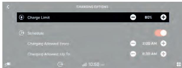
Il display del veicolo passerà alla schermata di ricarica. La carica continuerà fino a quando lo stato di carica della batteria non raggiungerà il livello selezionato o fino a quando la EVSE non verrà scollegato.
