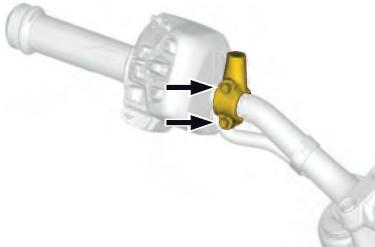
5. Con il conducente al posto di guida, ruotare il morsetto dello specchietto nella posizione desiderata.
