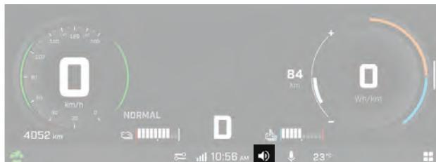
Il volume può essere regolato tramite l'interruttore multifunzione o l'icona del volume sulla barra di stato sul touchscreen.
