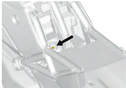
posizione della vite di regolazione della compressione
