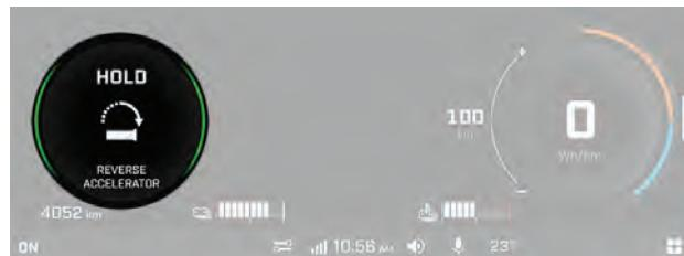
6. Con la manopola dell'acceleratore ruotata lontana da sé, premere il pulsante di avvio per attivare il sistema di propulsione ad alta tensione.
