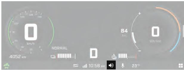
Il volume può essere regolato tramite l'interruttore multifunzione o l'icona del volume sulla barra di stato sul touchscreen.
