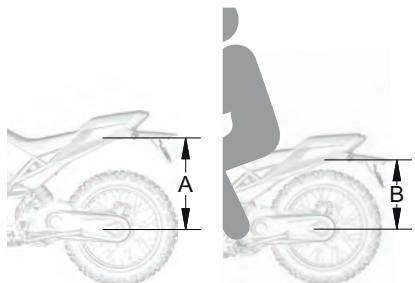
2. Calcolare il valore del cedimento (SAG) misurato (mSag) attraverso la seguente formula:
