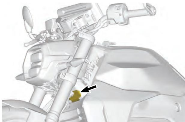
Emplacement de l'étiquette d'identification du véhicule
