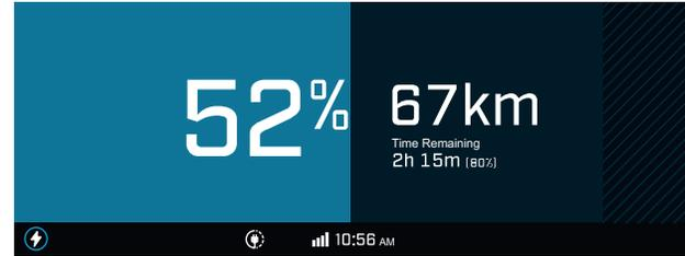
Pendant que la charge se poursuit jusqu'à son terme, en fonction du niveau de charge sélectionné, l'écran s'éteint après 30 secondes d'inactivité. Touchez l'écran pour réactiver l'affichage si vous le souhaitez ou insérez la clé pour modifier l'option de charge.
