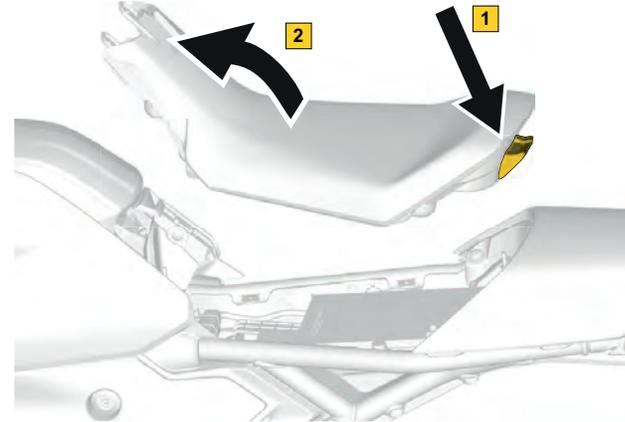
2. Installez les deux fixations avant de la selle du conducteur et serrez-les selon les spécifications.
