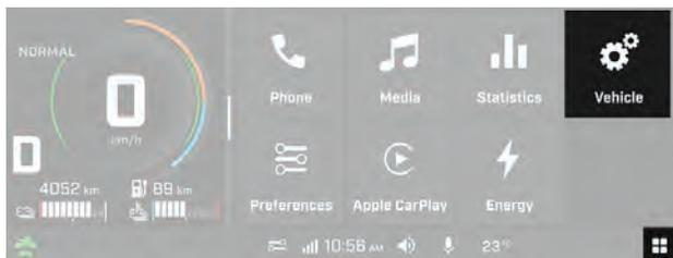
Une fois dans les Paramètres du véhicule, le conducteur peut sélectionner l'icône du pignon et modifier indépendamment les deux modes de régénération.
