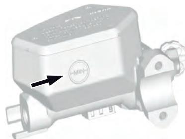
4. Vérifiez le niveau de liquide de frein dans le réservoir arrière. Le niveau de liquide doit se situer entre les repères UPPER et LOWER (Haut et Bas).
