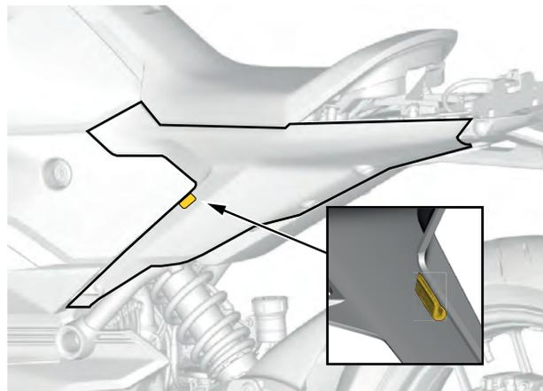
2. Installez les fixations du carénage latéral arrière.
