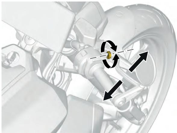
La position du levier de frein avant peut être réglée en tournant la molette de réglage située au début du levier, entre le levier et la poignée d'accélérateur. En tournant la molette dans le sens des aiguilles d'une montre ou dans le sens inverse, on règle la distance entre le levier et la poignée d'accélérateur.
