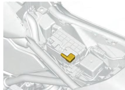
4. Installez les vis de fixation du support de la batterie.
