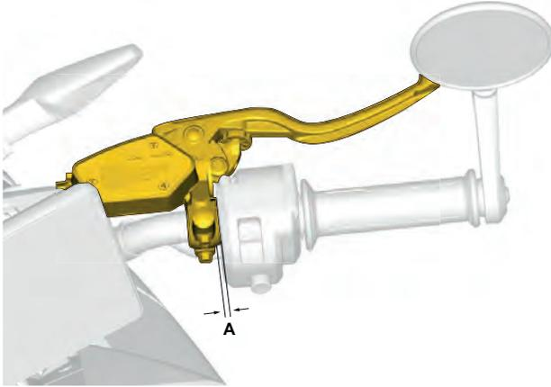
A. 0 à 5 mm (0 à 0,197 po) mesurés entre le point sur le guidon et le côté du levier de frein.
