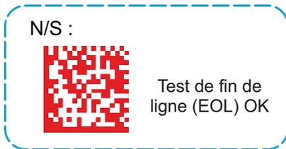
Étiquette Numéro de série Batterie à haute tension
