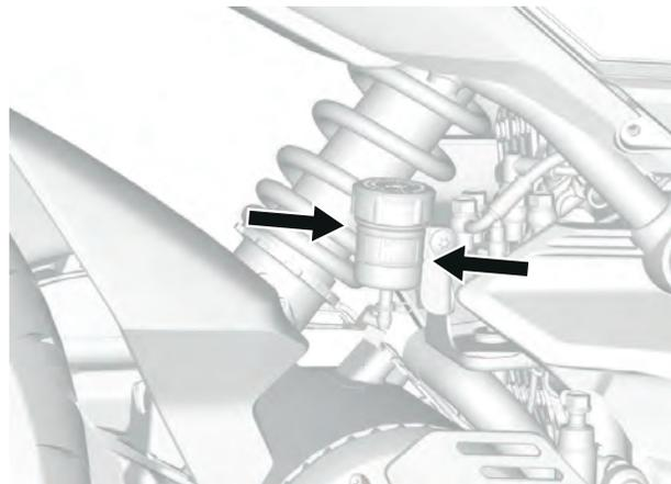
5. Réinstallez la membrane du réservoir et son couvercle.
