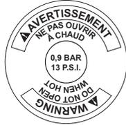
**Bouchon du réservoir de liquide de refroidissement**
