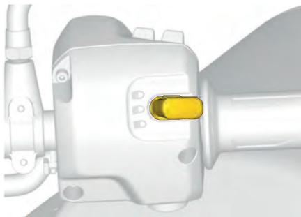
Ce commutateur permet d'activer et de désactiver les feux de route. Les feux de croisement s'allument automatiquement lorsque le véhicule est activé et s'éteignent lorsque le véhicule est éteint.
