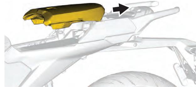
2. Appuyez sur le bouton de verrouillage pour fixer le siège au véhicule.
