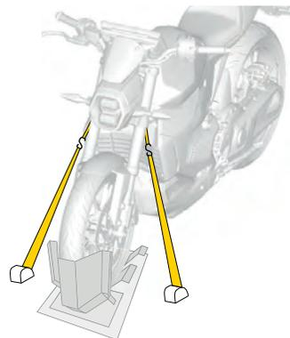
7. Passez la courroie de fixation dans la jante de roue arrière seulement. Ne pas passer la sangle d'arrimage au-dessus du bras oscillant et ne pas utiliser les rayons de roue pour fixer le véhicule.
