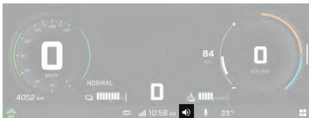
Le volume peut être réglé à l'aide du commutateur multifonction ou de l'icône de volume sur la barre d'état de l'écran tactile.
