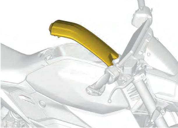
2. Tirez le couvercle de la boîte à gants vers l'arrière pour le sortir du véhicule.
