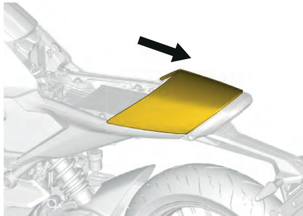
2. Installare il sedile del conducente. Fare riferimento a [Installazione del sedile del conducente, pagina 3-25](#).
