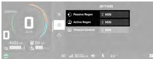
La disponibilità della frenata rigenerativa varia in funzione di queste impostazioni e di altri parametri come lo stato di carica e la temperatura della batteria ad alta tensione. Il display multifunzione mostrerà sempre la capacità di frenata rigenerativa attualmente disponibile come descritto nella sezione [Display multifunzione touchscreen 10,25", pagina 3-45](#).
