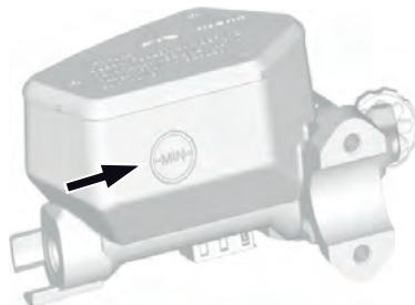
4. Verificare il livello del liquido dei freni nel serbatoio posteriore. Il livello del liquido deve essere compreso tra la tacca SUPERIORE e quella INFERIORE;
