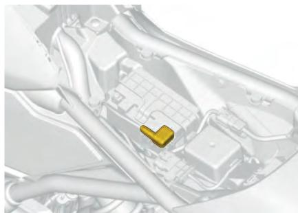
4. Installare le viti della staffa della batteria.
