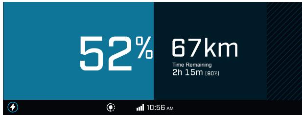
Anche se la carica continuerà fino al completamento, in base allo stato di carica selezionato, il display si spegnerà dopo 30 secondi di inattività. Toccare lo schermo per riprendere la visualizzazione, se lo si desidera, oppure inserire la chiave per cambiare la selezione del livello di carica.
