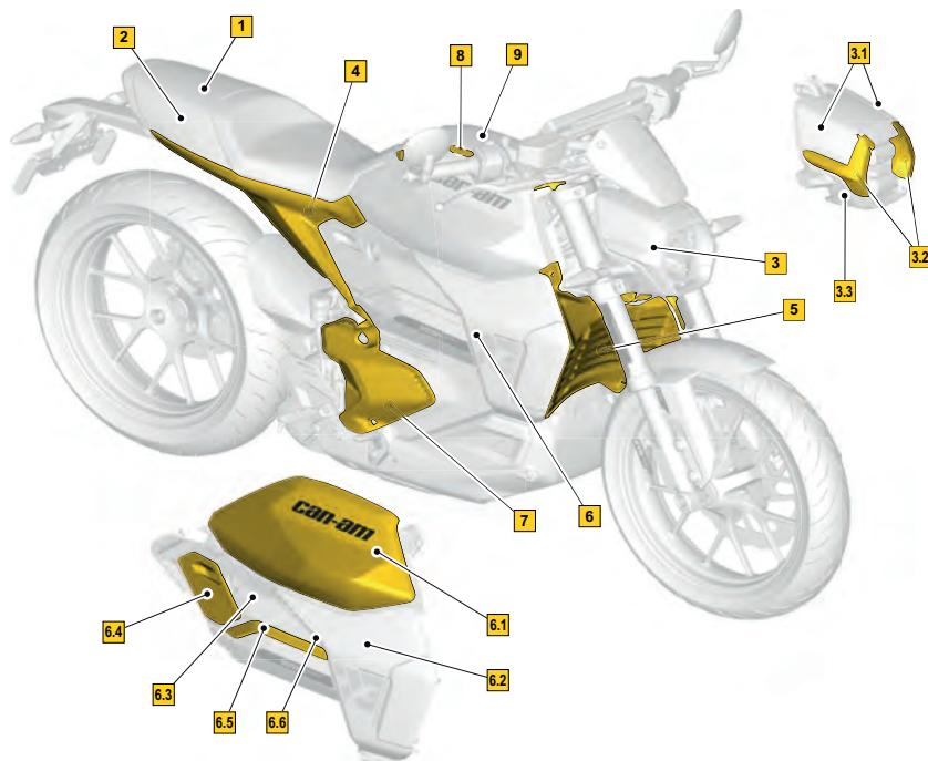
1. Carenatura superiore posteriore (se in dotazione)
