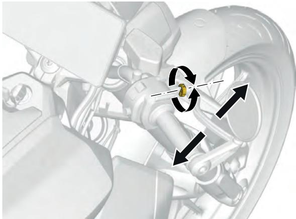
La posizione della leva del freno anteriore può essere regolata ruotando la rotella di regolazione situata all'inizio della leva, tra la leva e la manopola dell'acceleratore. Ruotando la rotella in senso orario o antiorario si regola la distanza tra la leva e la manopola dell'acceleratore.
