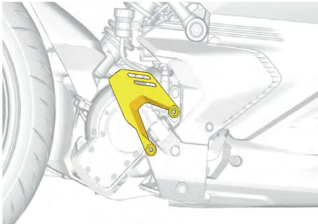
2. Installare i dispositivi di fissaggio del paratalloni.
