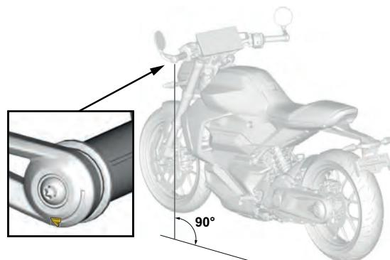
5. Afferrare il supporto e serrare il dispositivo di fissaggio.
