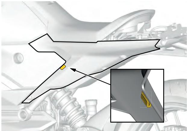
2. Installare i dispositivi di fissaggio che trattengono la carenatura laterale posteriore.
