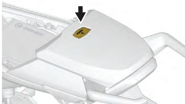
3. Controllare che il sedile sia correttamente bloccato nella posizione corretta prima di usarlo.
