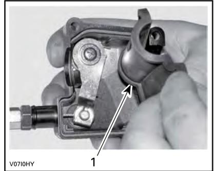
1. Protezione interna dell'alloggiamento
