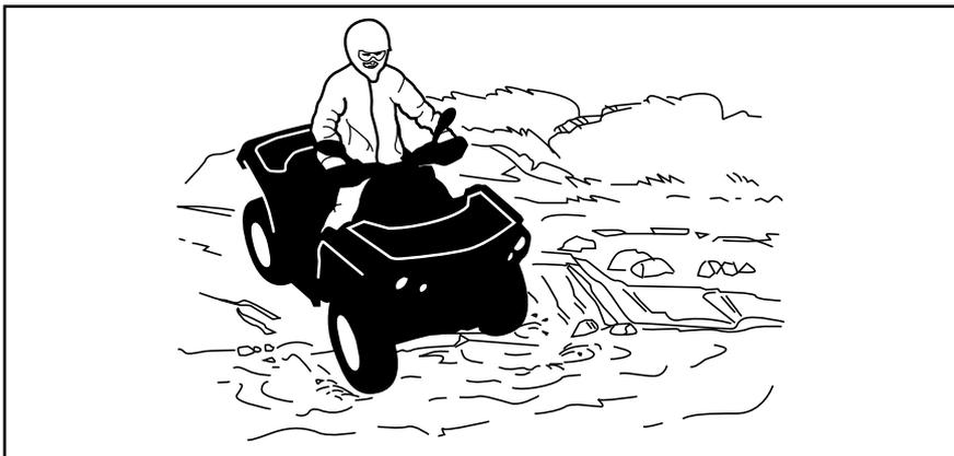
I freni bagnati compromettono la capacità di frenata del veicolo. Accertarsi che i freni siano asciutti frenando diverse volte dopo essere usciti da acqua, fango o neve. Lasciare una maggiore distanza di sicurezza per la frenata.
