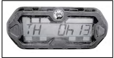
Pulse y MANTENGA presionado el botón selector durante 2 segundos para que el contador de horas se ponga a cero.
