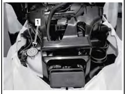
1. Tapón del depósito de refrigerante del motor
