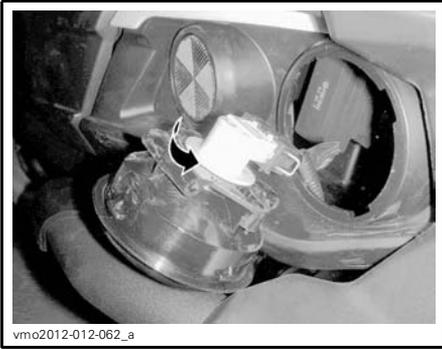
**ROTATE BULB COUNTERCLOCKWISE**
