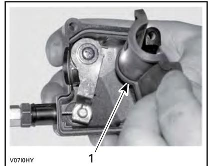
1. Protezione interna dell'alloggiamento
