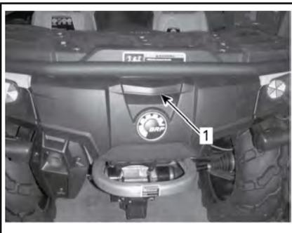
1. Dispositivo di chiusura del vano bagagli posteriore
