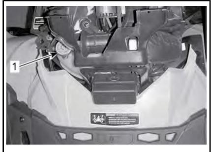
1. Tappo del serbatoio liquido refrigerante motore
