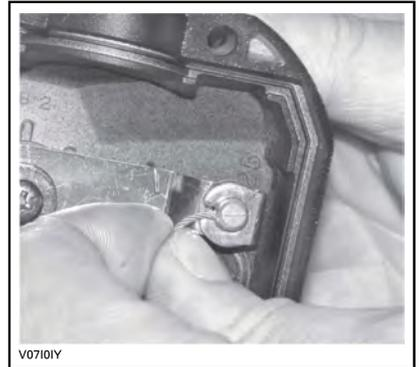
Entfernen Sie die Seitenabdeckung der Drosselklappe.
