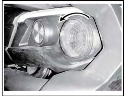
**RÜCKLEUCHE ZUM ENTFERNEN GEGEN DEN UHRZEIGERSINN DREHEN**
