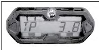
Pressione e SEGURE o botão seletor por 2 segundos para zerar o odômetro parcial.
