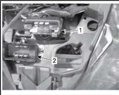
1. Vorderer Sicherungskasten
