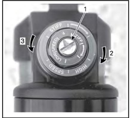
**EINFEDERUNGSDÄMPFUNG (NIEDRIGE GESCHWINDIGKEIT), (EINEN SCHRAUBENDREHER VERWENDEN)**
