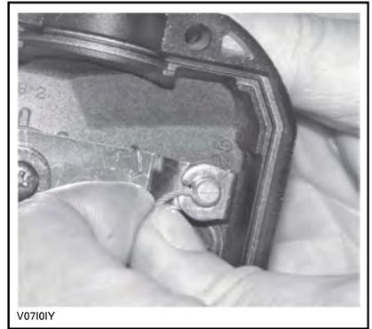
Entfernen Sie die Seitenabdeckung der Drosselklappe.
