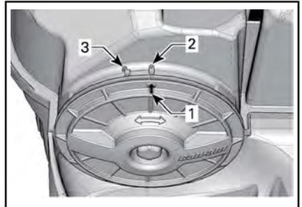
1. Flecha de la posición de la cubierta
