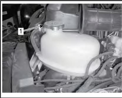
1. Tapón del depósito de refrigerante del motor
