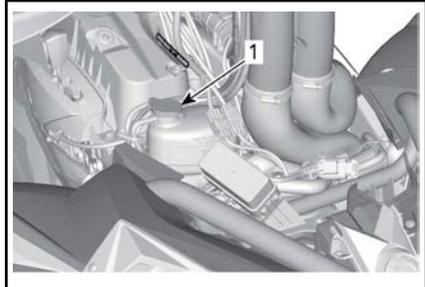
1. Tampa do reservatório do líquido de arrefecimento do motor
