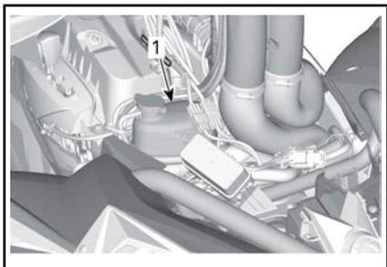
1. Reservatório do líquido de arrefecimento do motor
