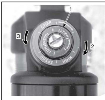
**AMORTECIMENTO POR COMPRESSÃO EM ALTA VELOCIDADE (USE UMA CHAVE INGLESA DE 17 MM)**
