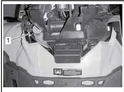
1. Réservoir de liquide de refroidissement
